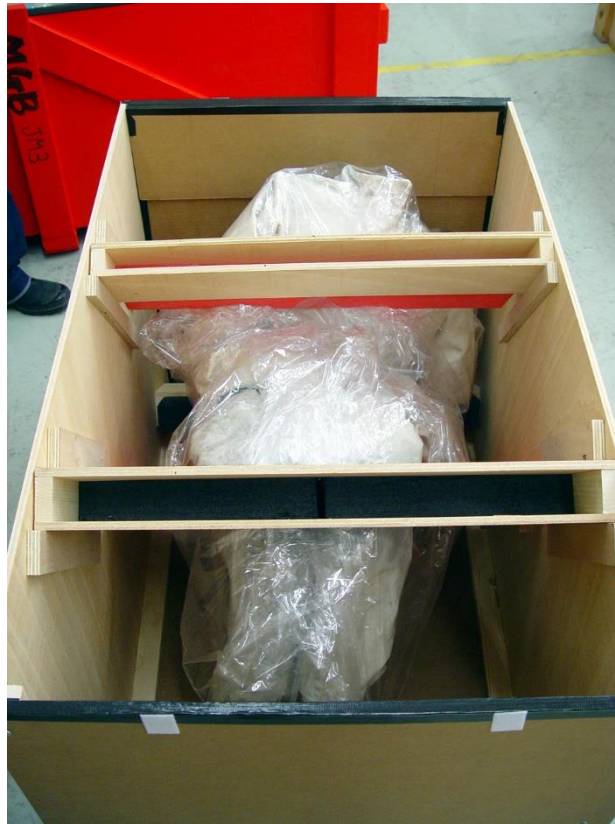
Abrazaderas interiores adaptadas a la forma de la obra de arte.
