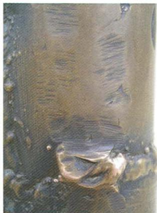
Fig. 5. Huellas de operaciones realizadas tras el vaciado de la pieza
